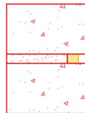
SET THE REGLET IN THE JOINT 5/8" [16mm] MIN. REGLET SHOULD BE SPRING LOCKED IN THE JOINT. LOCK WITH WEDGES 12" OC. FILL THE JOINT WITH SEALANT AND TOOL
